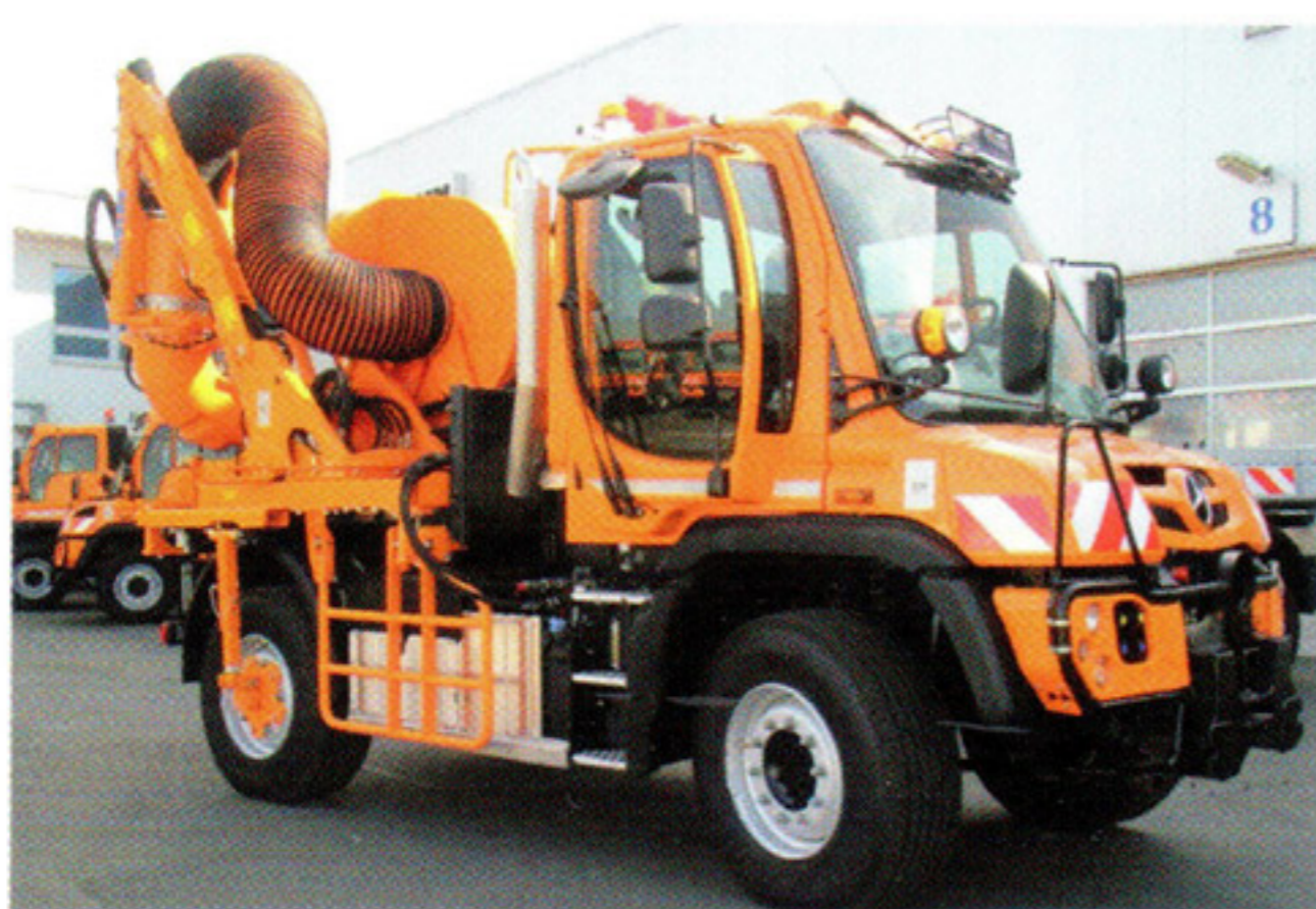
MB Unimog U 427 s ramenovou sekačkou s odsáváním MULAG typ SB 500
