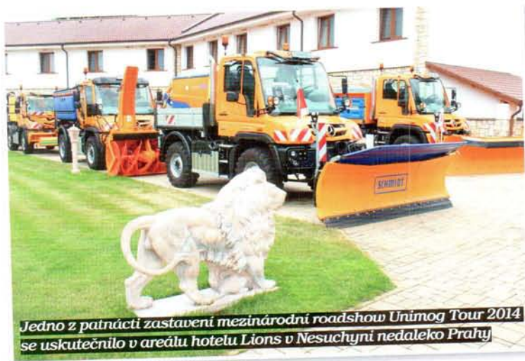
Unimog U 423 je vhodný pro použití na silnici i v terénu. Na snímku se sněžovou radlicí a sypačem Gmeiner
