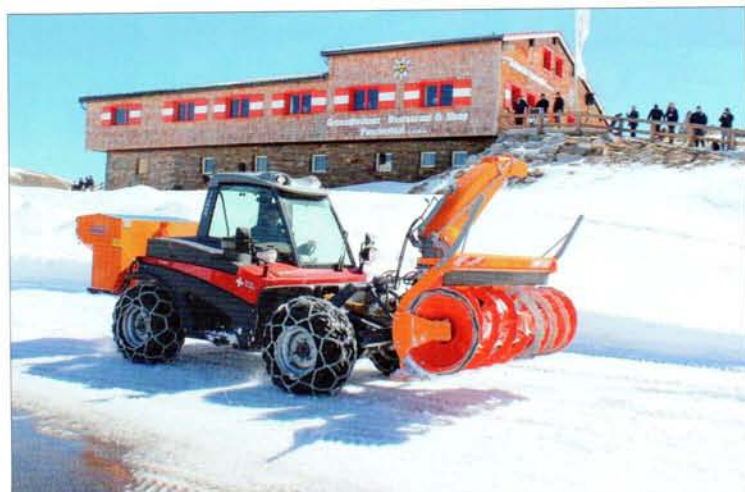
Dvounápravový svahový nosič Aebi TT280 zvládá náročnou práci ve svažitých terénech
