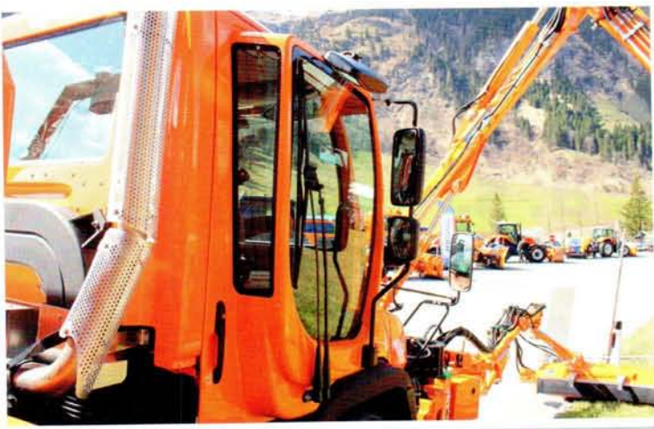
Pravé dvere s panoramatickým sklem poskytujú kromě dobrého výhľadu také prostor pro nohy obsluhy, pokud sedí otočená o devadesát stupňů do strany. Uvnitř je spínač pro ovládání stěrače, který se dobře využije pro odstranění prachu v průběhu práce
