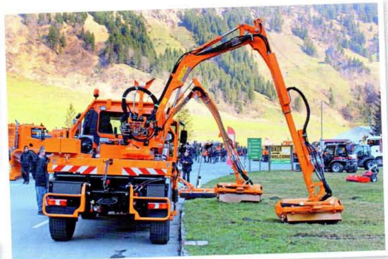
Konzola zadního vyžinače MHU 800 se připevňuje na montážní prostor za kabinou, takže zatížení se na nosič přenáší rovnoměrně. Zadní vyžinač MHU 800 s dosahem 7,3 m může pracovat vpravo i vlevo
