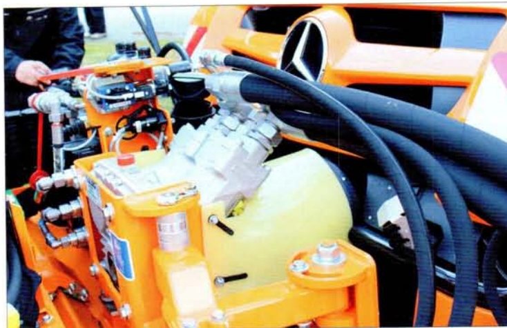
Přes krátkou přední část Unimogu je velmi dobrý výhled na připojená zařízení. Dvojici předních vyžinačů MKM 700 pohání výkonný hydrogenerátor, napojený přímo na přední vývodový hřídel
