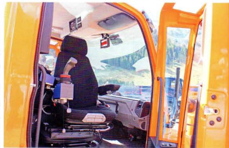
Sedačka spolujezdce může být v otočném provedení. Je rovněž pneumaticky odpružená a joystick v loketní opěrce slouží k ovládání zadního příkopového ramene
