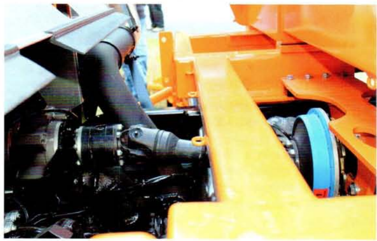
Vyžinač MHU 800 odebírá výkon od přidavného pohonu motoru. U nové řady nosičů Unimog je tento pohon inovován a poskytuje řidiči výhodu jednoduchého ovládání
