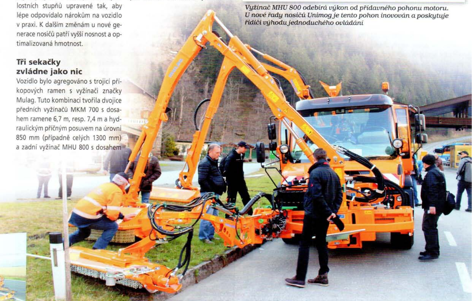
Unimog U 530 v agregaci s trojicí vyžinačích ramen se těšil značné pozornosti přítomných odborníků. Nosič měl celou řadu zajímavých prvků výbavy na prání a pohon nástavby byl čistě mechanický
